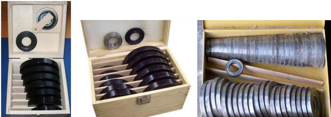
**Figure 19 Boîtes de guide à bille 9 \_ 14 et 49**
