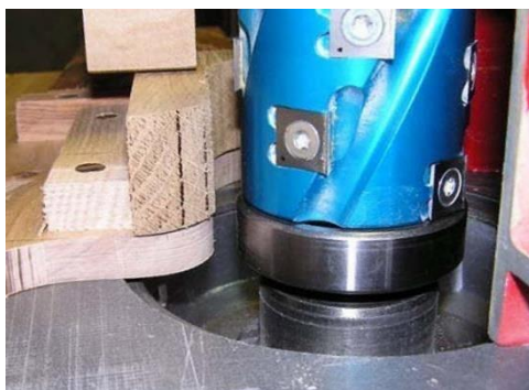
Figure 16 Calibreur et son roulement
