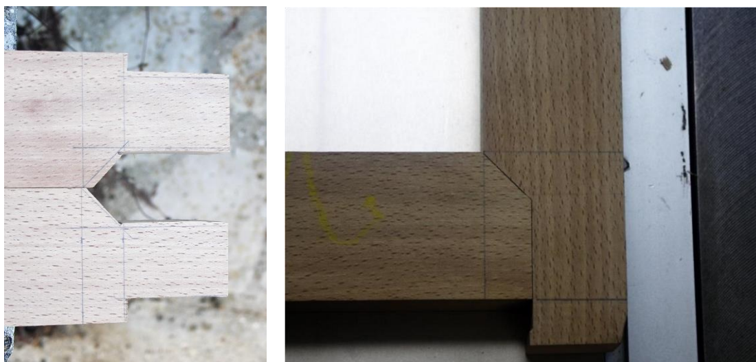
Figure 35 Tracé et ébauche des tenons de traverses puis des montants
