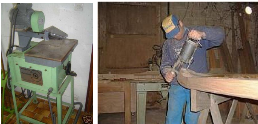
Figure 31 Un des premiers modèles de moulurette Thomas et la toupie Resch
